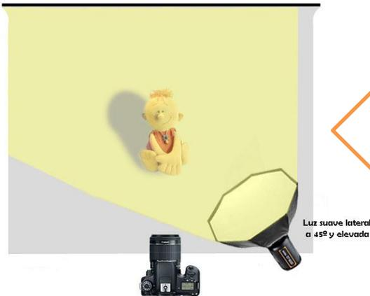
Esquema con 1 solo punto de luz suavizada mediante el empleo de una ventana colocada lateralmente a unos 45° entre la cámara y el modelo e iluminando ligeramente hacia abajo desde unos 2 metros de altura aproximadamente.
