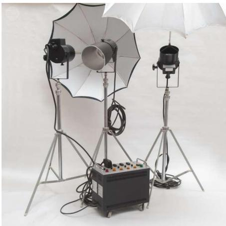
mayor potencia que se alimentan de generadores conectados a la red eléctrica. En exteriores disponemos de equipos ligeros que se pueden portar con el equipo y que se alimentan con baterías. Hay una gama muy amplia de flashes en función de su potencia y de su operatividad. Esto los hace muy versátiles.
